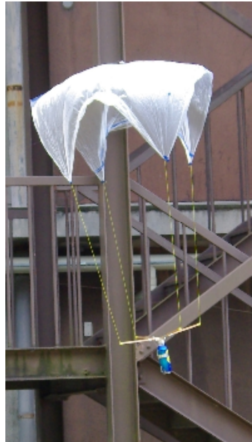
図 3.4.3. : 2 スタビライザーを取り付けた CanSat II
