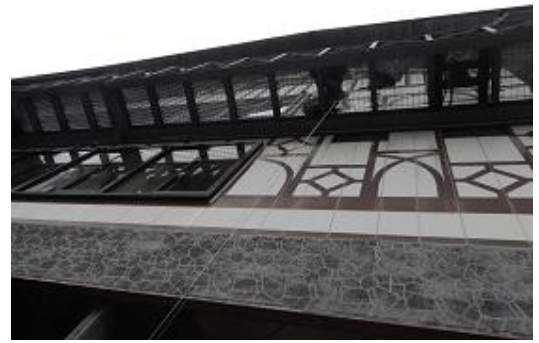
乗鞍バスセンターの2FとBF1の差を利用して、2種類の長さの振り子を設置した。
