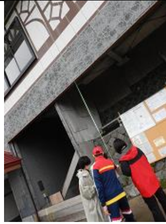
乗鞍バスセンターの2FとBF1の差を利用して、2種類の長さの振り子を設置した。
