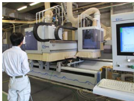
NC加工機にプログラミングして材料を加工中
