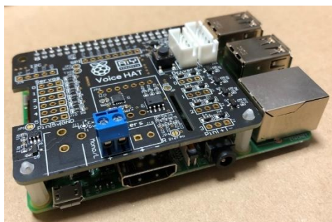
図1 RaspberryPi3とVoice HAT ボード
