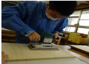
図6 サンダーによる表面仕上げ
