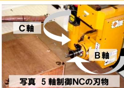
写真 5軸制御NCの刃物
