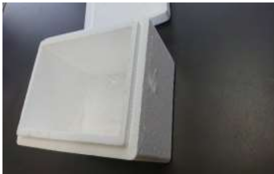
図1：においの実験で使用した発泡スチロール箱。底にサランラップを敷き、においセンサの先端が中の空気が逃げることなく入れられるように側面に直径1 cm程の穴をあけてある。
