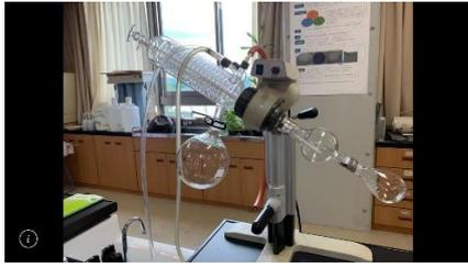
図3 減圧式蒸留装置
