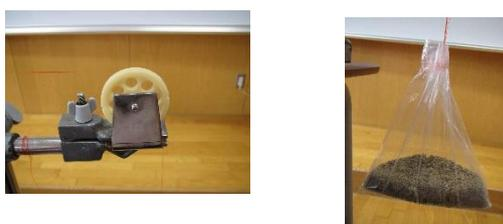
図8 滑車の取り付け図 図9 砂袋の取り付け図
