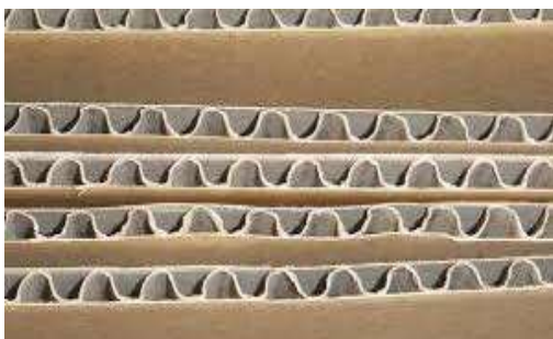
図1 段ボールの内部構造
