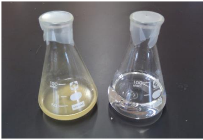
図8 右) 常圧蒸留で取り出した液体 左) 減圧蒸留で取り出した液体
