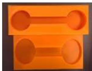
図VI今回の実験のために作った器具。ABS樹脂で作っている。
