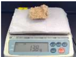
図III水分量 0%のくち木、純水は加えていない。
