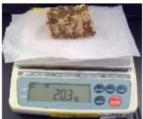
図V水分量 100%のくち木、純水を 10.1g 加えてある。
