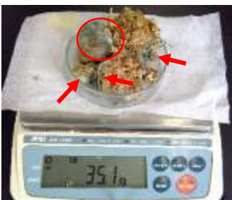
図IX 100%のくち木、カビが中まで生えた。円は覆った表面を表している。矢印は内部に生えたカビを表している。
