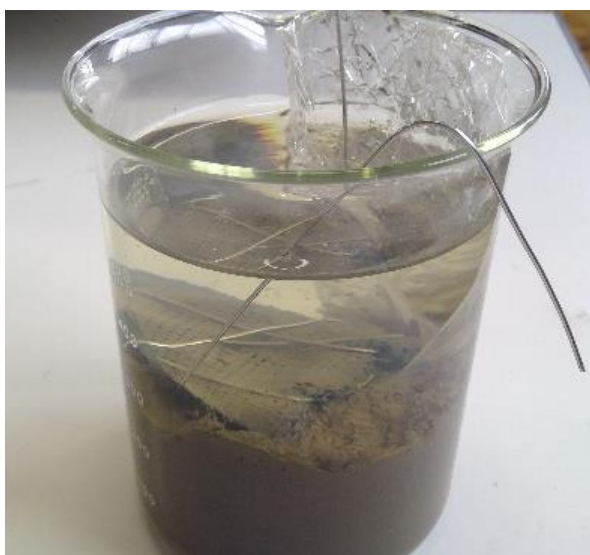
図 9 発電装置（実験-4 のために新しく作成した発電装置）
