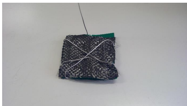
図6 作成した電極2 (ニッケル線を使用)
