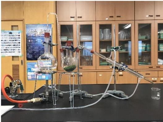
図 2 : 水蒸気蒸留の装置
