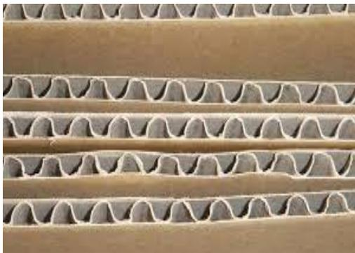
図1 段ボールの内部構造
