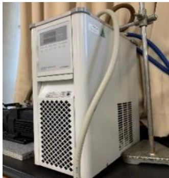
図6 (1 2) 冷却水循環装置
