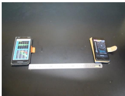
図1 音源装置と測定装置を 300 mm 離す
