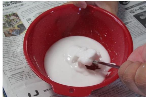
図3 混合物でダイラタンシー現象が匙の衝撃によって発生している様子
