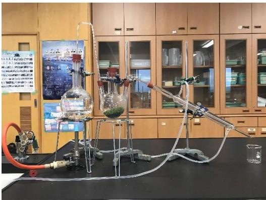
図2 水蒸気蒸留の装置
