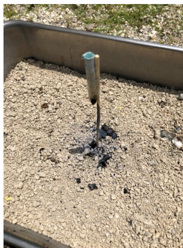
図3 過塩素酸カリウムを燃やした後
