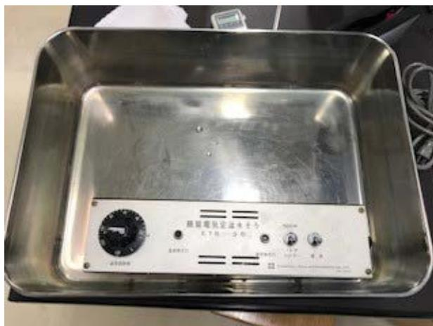
図4 簡易電気定温水槽
