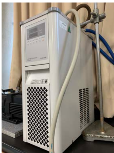
図 5 (1 2) 冷却水循環装置
