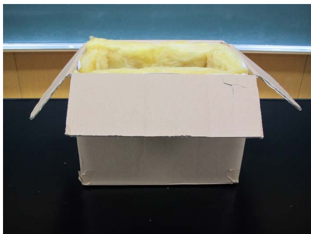
図 5, 6 内部にメラミンスポンジ（激落ちくん）を貼り付けた段ボール
