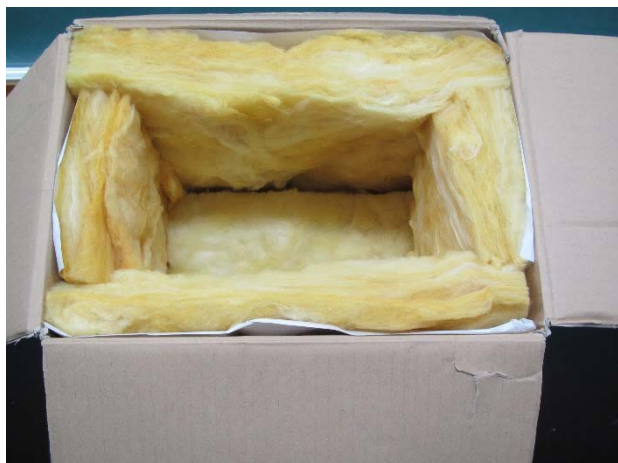
図 3, 4 内部にグラスウールを貼り付けた段ボール
