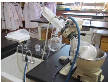
ロータリーエバポレーター
