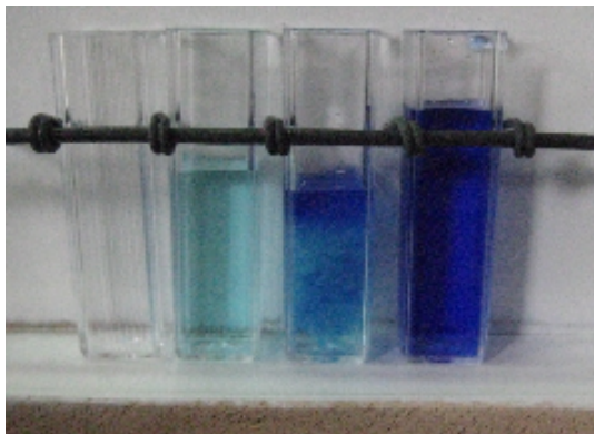
銅(II)イオンとアンモニア水(NH 3 )との反応 青白色沈殿 Cu(OH) 2 、深青色溶液[Cu(NH 3 ) 4 ] 2+ の様子
