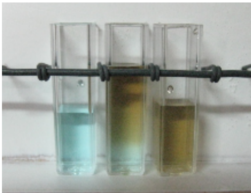
銅(II)イオンと硫化水素水(H 2 S)との反応 黒色沈殿 CuS の様子
