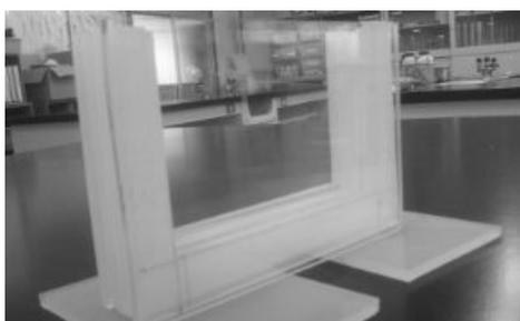
このセルは、はじめアクリル板ではなく、ガラス板を使っていたが、接着面での水漏れやセルの重量など、扱いにくい部分が多かったのでアクリル板に変えた。
