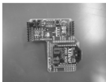
↑XBee 無線通信モジュール
